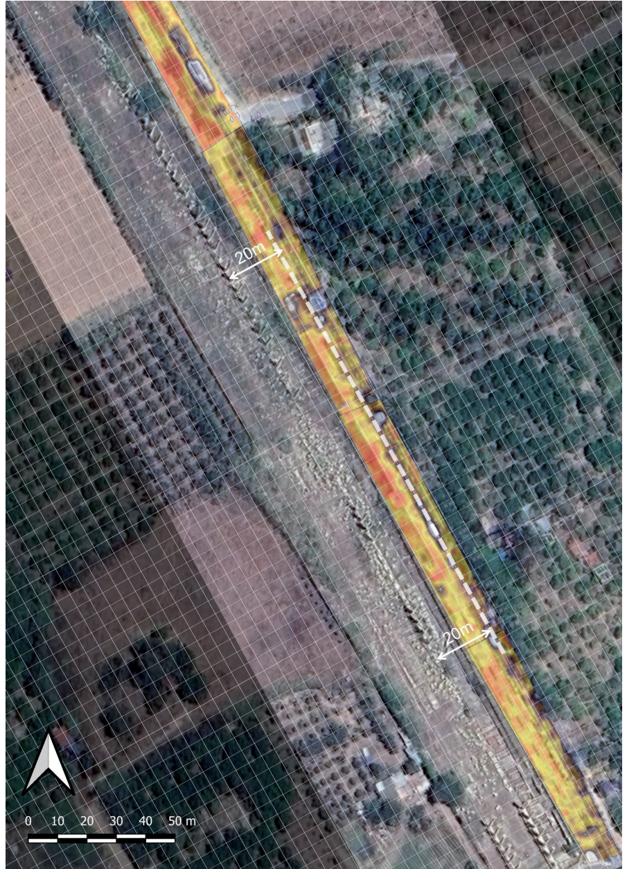
Resim 4. Liman Caddesi'nin doğusunda yer alan yürüyüş yolunda gerçekleştirilen Jeoradar ölçümlerine göre oluşturulan raster veri
